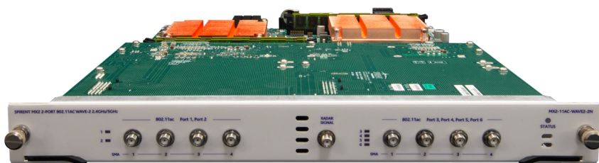
图1：适用于802.11 a/b/g/n/ac WLAN Wave-2和DFS雷达信号仿真的MX2测试模块
