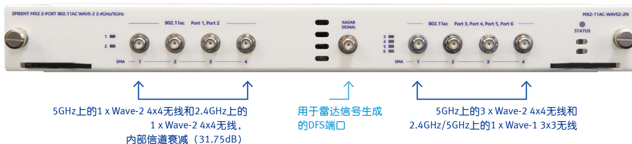
图2：包含多无线端口和雷达信号生成端口的MX2 Wave-2 DFS测试模块
